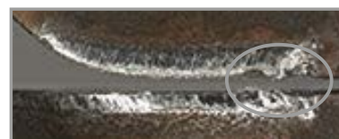
Filo de corte dañado
